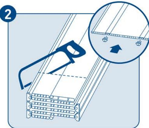
Medir a altura do vão livre e diminuir 4cm, traçando uma linha reta na parte inferior da articulação da PortaFlex. Efetue o corte, com mão firme, usando um arco de serra para metais. Retire eventuais rebarbas resultantes do corte e recoloque as devidas tampas de união e parafusos na posição original. Em seguida, corte os Montantes e o Gancho 2cm menor do que a altura do vão livre.
