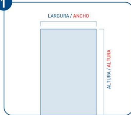
Antes de iniciar a instalação, verifique as medidas de largura e altura do vão livre. Se a altura do vão for menor que 2,10m (medida padrão de nossas portas), siga as instruções do passo 2. Caso contrário, siga diretamente para o passo 3.
