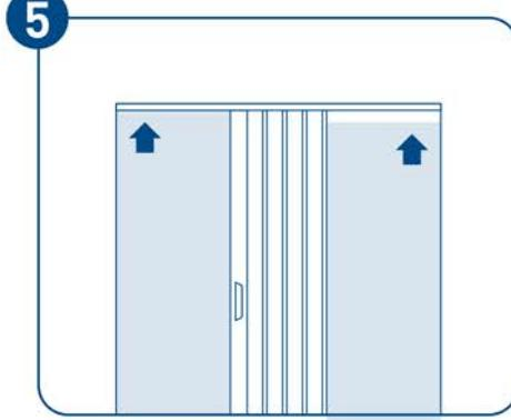
Volte a Guia na posição e finalize a fixação com os parafusos 4,2x32mm.
